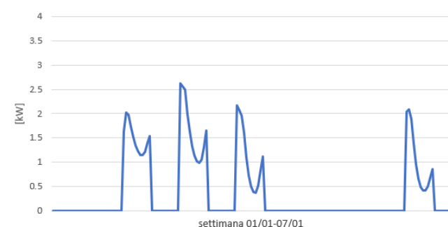
Figura 2.27 – Simulazione di un profilo di consumo elettrico per pompe di calore con terminali ambiente ad aria per un edificio adibito a uffici nella città di Milano [Fonte: Elaborazione Fondazione Politecnico]
